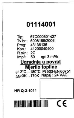
Slika 4: Primjer natpisne pločice računске jedinice mjerila toplinske energije tipa MULTICAL 601
